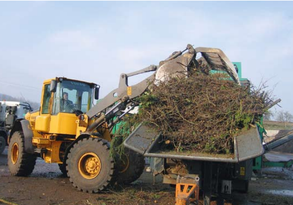
Schaufel mit hydraulischer Halteklappe von HS-Schoch
