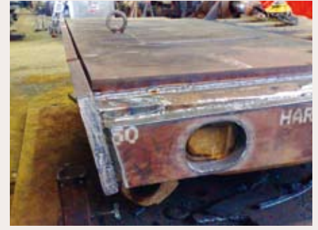
BEI DER LÖFFELREGENERATION kamen 18 Rollen Schweißdraht und 5884 kg Harbox zum Einsatz. Fotos: HS-Schoch
